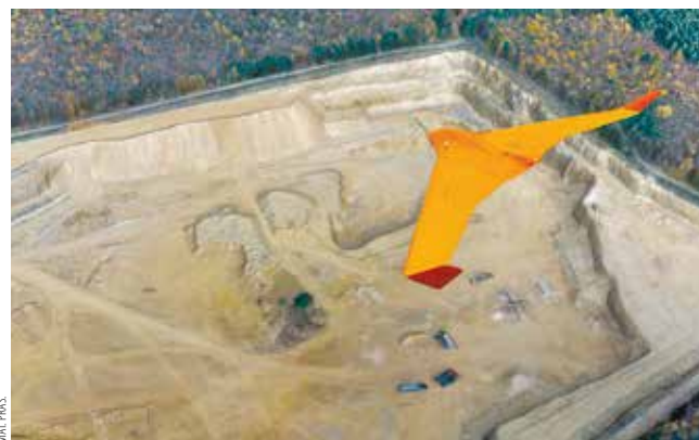
Bezzałogowy system fotolotniczy Bramor gEO podczas pomiaru kopalni dolomitu.
